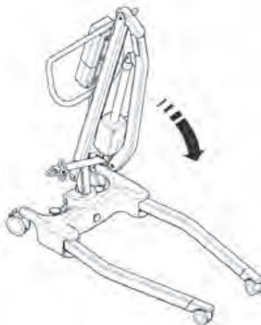
**4.** Til de opgevouwen Advance rechtop (met behulp van het onderstel en de duwbeugel als richtlijn); zorg ervoor dat de mast en tilarm samen blijven wanneer u het apparaat rechtop zet.
