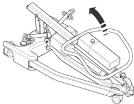
4. Heben Sie den kompletten Mast aufrecht an (mit der Oberseite des Schiebegriffs) und senken Sie den Mast so in die Aussparung (1) ausgerichtet sind, ziehen Sie die Einrastknöpfe für den Mast (2) fest und lösen Sie die Bremse an den Lenkrädern (3).
