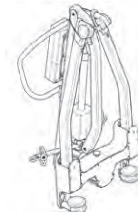
2. Dégagez le pied et le mât en détachant la sangle de retenue des roues. Cette sangle rentrera dans le haut de la section du mât.
