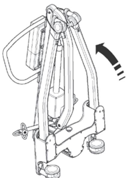
**5.** Ziehen Sie den Halteriemen steil nach oben, und legen Sie ihn über die Laufrollen. (Mit dem Riemen werden Fahrgestell, Mast und Ausleger für Transport und Lagerung arretiert).
