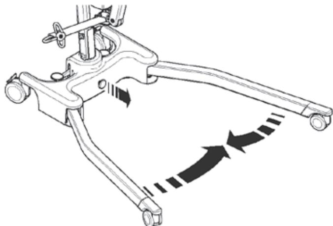
**3.** Maak het vergrendelingsmechanisme van de mast voldoende los zodat de mast omhoog worden getild. Til de mast volledig omhoog totdat de bovenste stop is bereikt. Vouw de mast voorzichtig in de richting van het onderstel. Hierbij kan ter ondersteuning het duwhandvat worden gebruikt.
