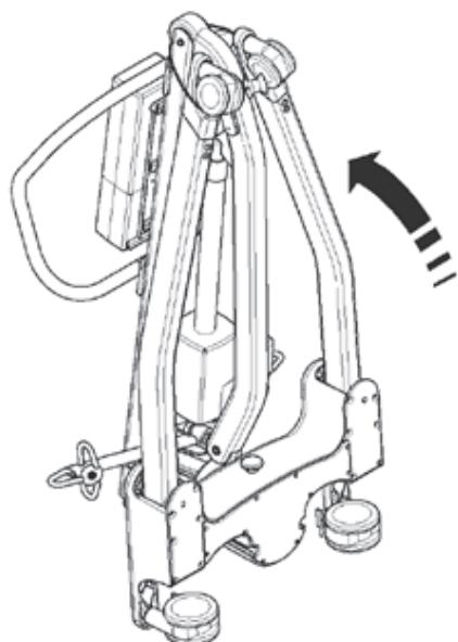
**5.** Trek de bindriem hard omhoog en breng deze aan over de wielen (Dit zorgt ervoor dat onderstel, mast en tilarm goed samen blijven tijdens transport en opslag).
