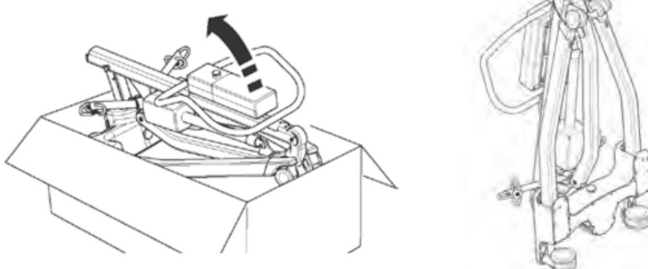
**2.** Suelte la pata y el conjunto del mástil aflojando la correa de retención de las ruedas. Esta correa se retrae completamente en la parte superior de la sección del mástil.
