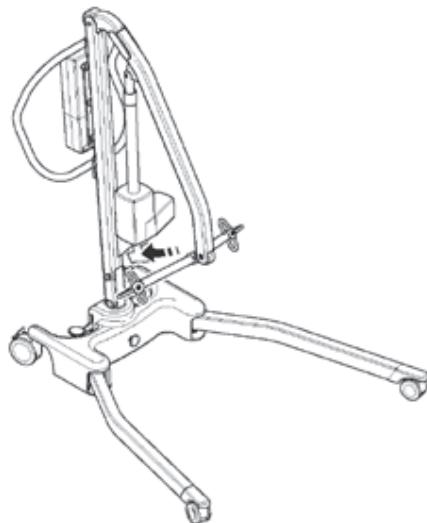
**2.** Schakel de onderstelvergrendeling uit (door deze van het voetstuk weg te trekken), sluit het onderstel.
