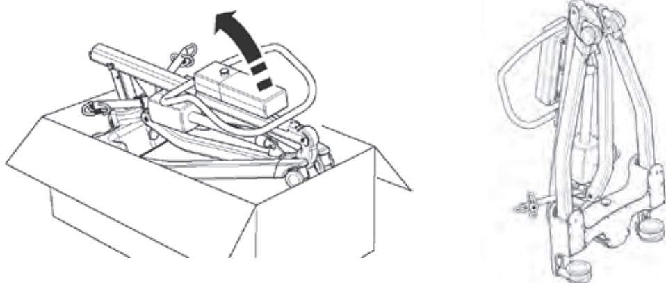
2. Lösen Sie Fahrgestell und Mast-Baugruppe, indem Sie den Halteriemen von den Rädern entfernen. Der Riemen wird im oberen Bereich des Mastes eingezogen.
