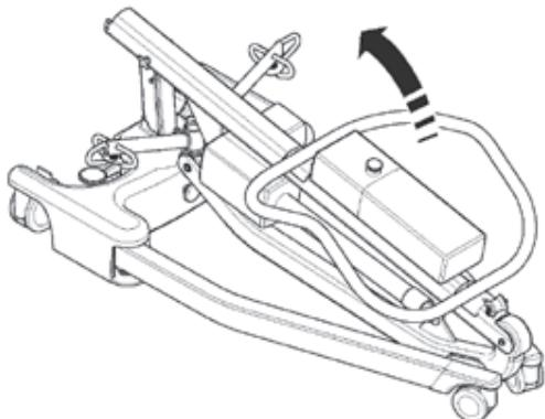
4. Til het mastelement rechtop (met behulp van de bovenkant van de duwbeugel) en laat de mast in de opening zakken (1), draai de mastvergrendelknoppen aan (2), schakel de wielrem uit (3).
