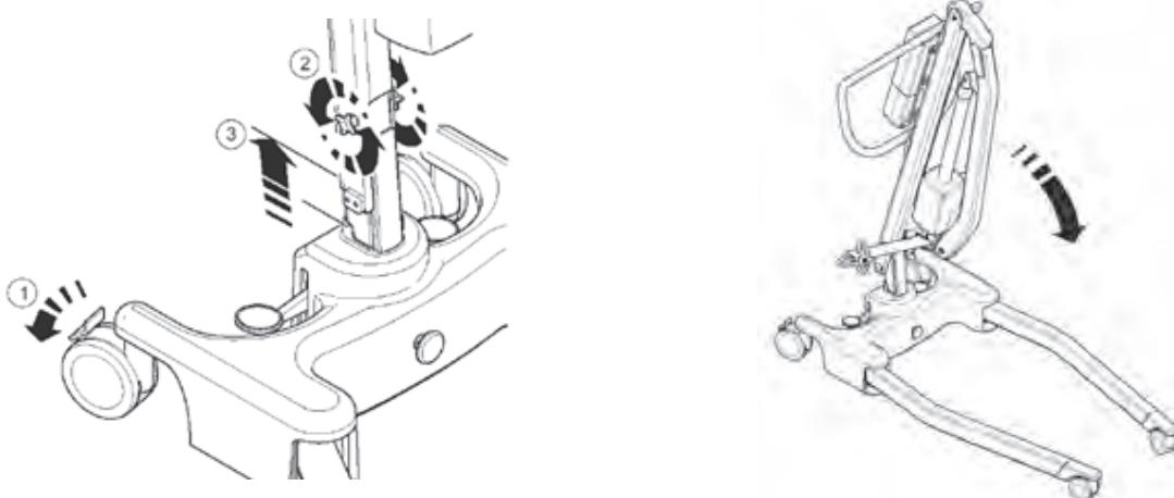
4. Soulevez l'appareil Advance verticalement (utilisez les pieds et la poignée de manœuvre comme guides) en veillant à ce que le mât et la flèche ne se séparent pas lorsque vous mettez l'appareil à la verticale.
