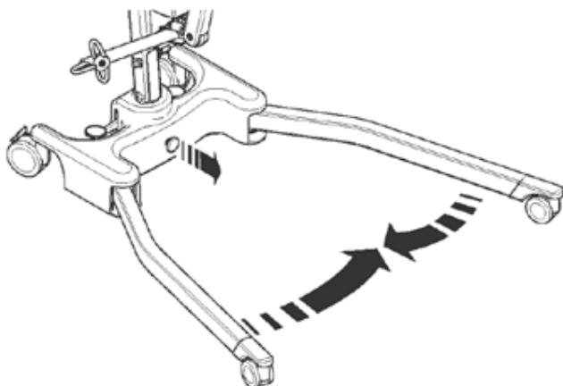
**3.** Lösen Sie den Mastfeststellknopf so weit, dass der Mast nach oben angehoben werden kann. Heben Sie den Mast ganz an, d.h., bis der obere Anschlag erreicht ist. Falten Sie den Mast vorsichtig zum Fahrgestell hin. Verwenden Sie dazu den Schiebegriff.
