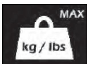
Als de tillift vanwege overbelasting stopt (een poging om meer dan de veilige belasting te tillen), verschijnt het symbool voor overbelasting op het LCD-scherm. De tillift houdt op te functioneren totdat het teveel aan gewicht (boven de veilige belasting) is verwijderd.
