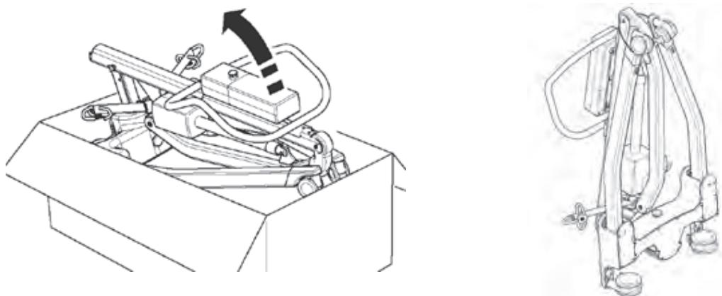
**2.** Maak onderstel en mast los door de bindriem van de wielen af te halen. Deze riem wordt netjes bovenin de mast ingetrokken.
