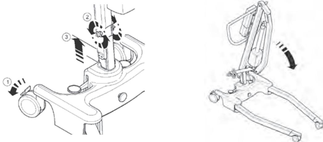
**4.** Levante el Advance plegado hacia arriba (utilizando las patas y el asa de empuje como guía), con cuidado de que el mástil y el larguero estén juntos al inclinarlo hacia arriba.
