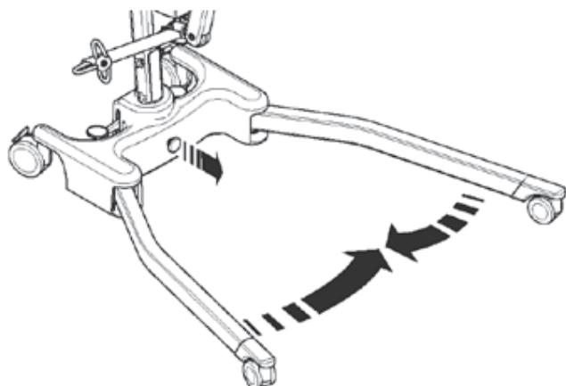
3. Desserrez suffisamment le dispositif de blocage du mât afin de pouvoir lever le mât. Levez le mât entièrement jusqu'à ce qu'il atteigne la butée d'arrêt. Pliez délicatement le mât en direction des pieds. Aidez-vous de la poignée pour faciliter cette action.
