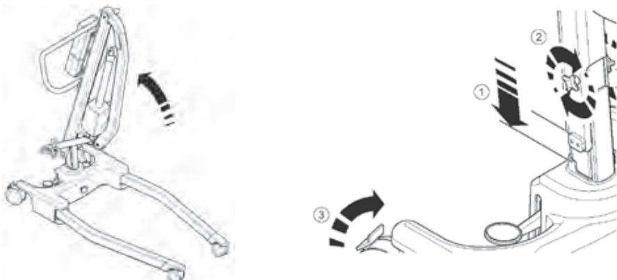
5. Abra las patas completamente. Asegúrese de que el botón de bloqueo de las piernas se enganche a ras de la base, así las patas ya no se moverán libremente. Las patas solamente funcionarán mediante el uso del mecanismo de pedal situado en la parte posterior de la base.
