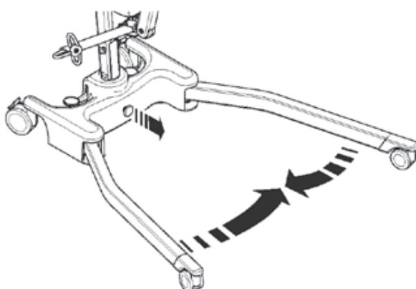
**3.** Afloje el dispositivo de bloqueo del mástil lo suficiente como para permitir la elevación del mástil. Levante el mástil completamente hasta alcanzar el tope superior. Pliegue el mástil con cuidado hacia las piernas. Utilice el asa de empuje para ayudarse a realizar a esta acción.
