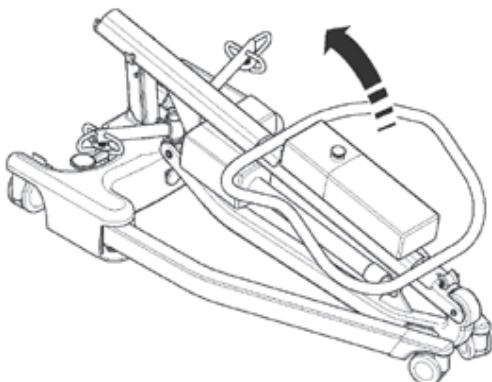
4. Levante el conjunto de piezas del mástil en posición vertical (utilizando la parte superior de la empuñadura) y coloque el mástil en la ranura (1). Ajuste los pomos de fijación del mástil (2) y destrabe las rueditas (3).
