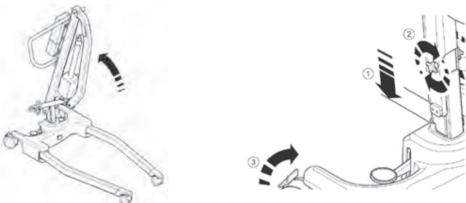
5. Spreidt het onderstel volledig. CONTROLEER of de vergrendelingsknop van het onderstel volledig in de basis is gestoken. Hierdoor kan het onderstel niet meer vrij bewegen. Het onderstel kan dan alleen bestuurd worden met behulp van het voetpedaal aan de achterkant van het voetstuk.
