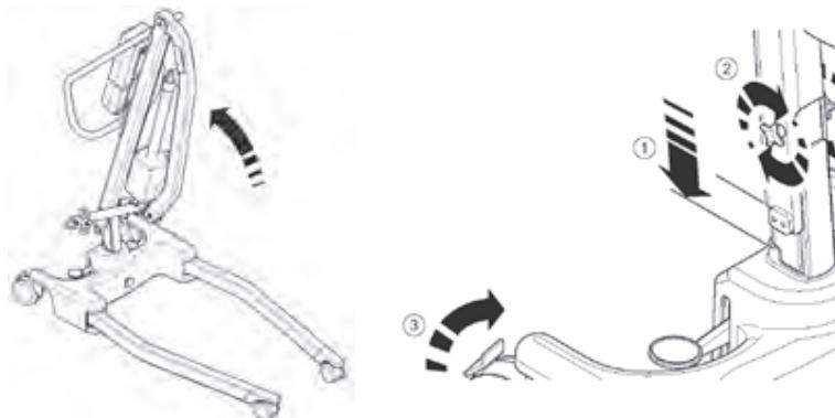
5. Spreizen Sie die Träger des Fahrgestells vollständig auf. VERGEWISSEN SIE SICH, dass die Fahrgestellsicherung ganz in das Gussteil hineingedrückt ist und das Fahrgestell sich nicht mehr frei bewegen lässt. Die Träger lassen sich dann nur noch mit dem Fußpedal auf der Rückseite der Basis verstellen.
